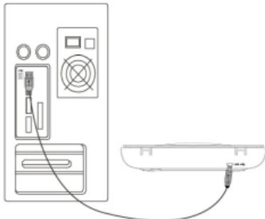
该型号扫描仪是USB接口的扫描仪，请参照上图按照如下步骤进行安装：
